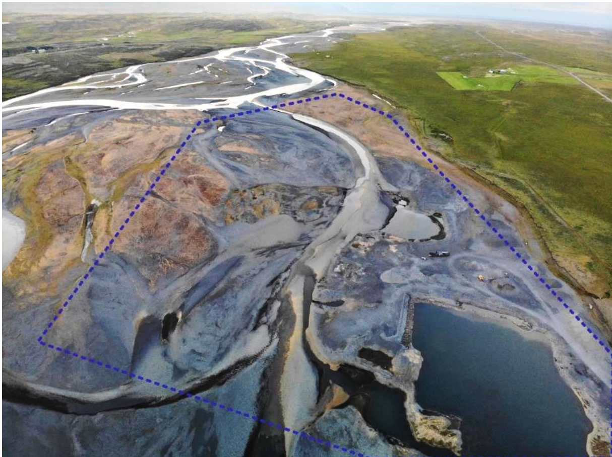
MYND 2.1 Horft yfir fyrirhugað efnistökusvæðis sem er afmarkað með blárri punktalínu. Núverandi efnistökusvæði sést niðri til hægri. Kvíslin fyrir miðri mynd er þurr stærstan hluta ársins en í vorflóðum og þegar Kárahnjúkastífla fer á yfirfall rennur um hana vatn.
