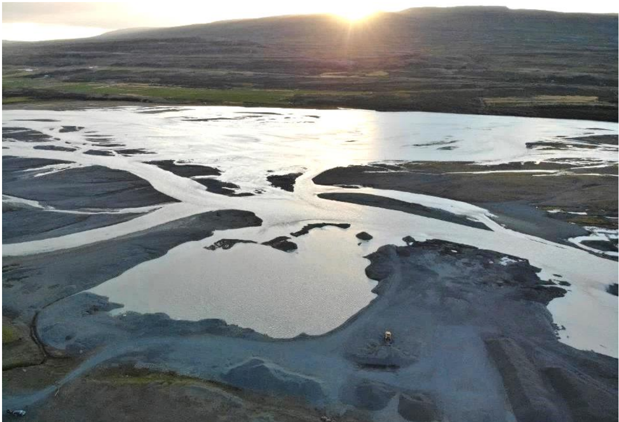
MYND 3.4 Mynd tekin 5. september 2021, það ár fór mikið vatn um yfirfall Kárahnjúkastíflu eftir mikið hlýindasumar og var rennslið um 400 m 3 /s þegar myndin er tekin. Þarna sést skarðið sem þarf að loka en það er ekki stórt og þarf þröskuldurinn ekki að vera mikið mannvirki. Hjólaskóflan í námunni er hvorki stór né áberandi í landslaginu.
